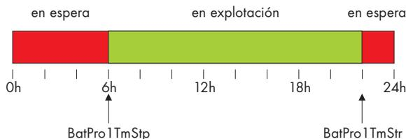
**Nivel 2:** El segundo nivel del modo de funcionamiento de protección se encarga de que el inversor arranque cada dos horas e intente cargar la batería desde el lado de CA, sólo en la ventana de tiempo donde se espera suficiente energía. En caso de las
